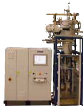
Doppelkammeranlage zum Abschrecken Double chamber furnace for quenching
